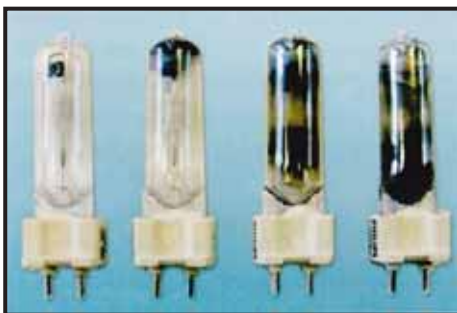
Divers stades du noircissement de l'ampoule extérieure de lampes CDM-T de Philips, conséquence du vieillissement et perte d'étanchéité du brûleur céramique. (Photos Philips).
