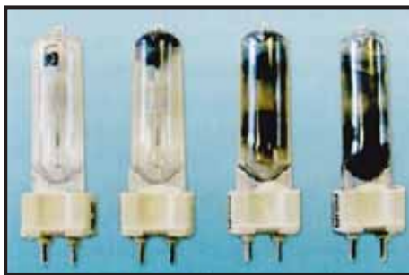
Verschiedene Stufen der Schwärzung des äusseren Hüllkolbens von CDM-T Lampen (Philips) infolge gealterter Keramikkbrenner auf Grund von Undichtigkeiten. (Bild Philips)
